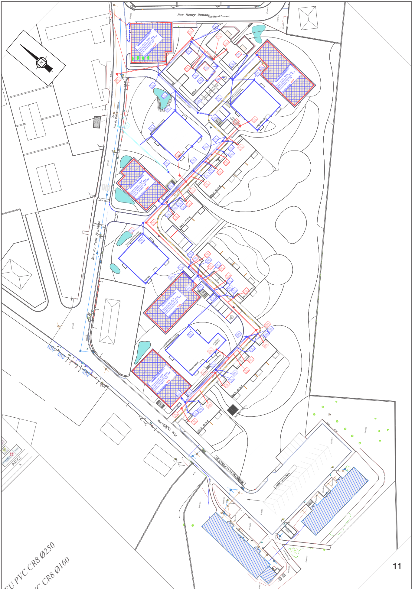
FIGURE 8 : DISPOSITIF DE COLLECTE DES EAUX
